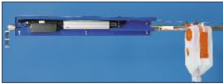
Automatisk udløsestation – kan åbne op til 100 volumendoserere samtidig
